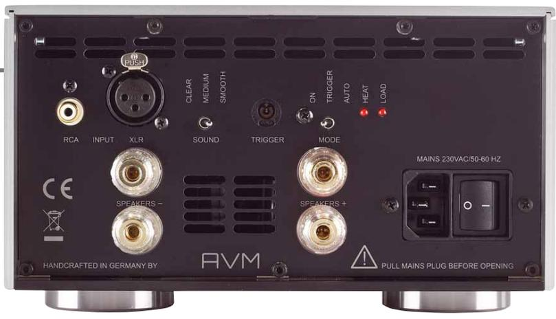
Die Endstufe schaltet sich bei Bedarf per Signal ein, außerdem gibt es kleine Schalterchen, die ein wenig „gutartigen“ Klirr erzeugen und so den Klang beeinflussen
